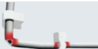
电缆线弯折，绝缘皮破裂
