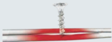
人为操作导致绝缘皮破损
